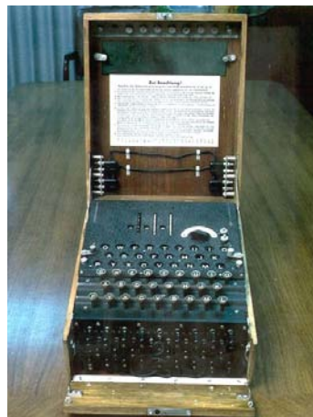
Panel de conexiones
