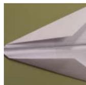
Alerón. Variaríamos su longitud. La anchura la mantendríamos de 1 cm, ya que en pruebas anteriores al introducirle mayor grosor el avión oscilaba mucho en el vuelo
