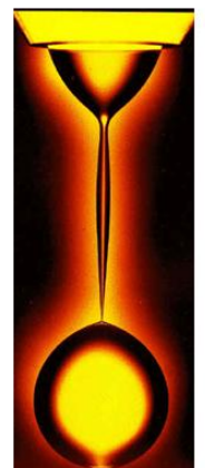
Desprendimiento de una gota
